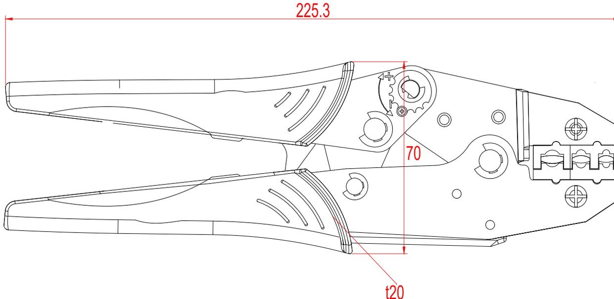
**Crimpzange für isolierte Kabelschuhe**
